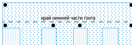
Уклон кровли более 60°
